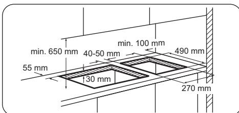
Als er meerdere kookplaten van 30 cm naast elkaar in dezelfde opening gemonteerd worden is hiervoor een montageset verkrijgbaar - bestaande uit een draagbeugel aan de zijkant en aanvullende afdichtingen - bij onze Klantenservice. De bijbehorende installatie-instructies zitten in de verpakking van deze set.
