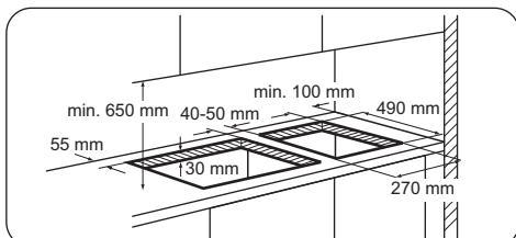
Verwenden Sie den Montage-Bausatz, der einen seitlichen Stützträger und zusätzliche
