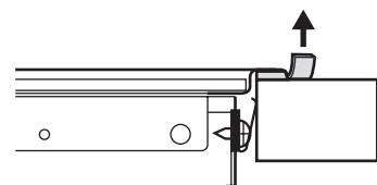
Placez la table de cuisson dans la découpe et poussez-la jusqu'à ce qu'elle soit en contact avec le plan de travail, puis enlevez le surplus de joint d'étanchéité.
